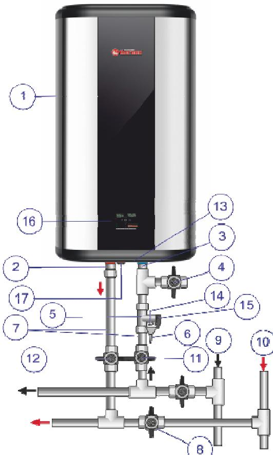
Fig. 1. Aansluitschema.
